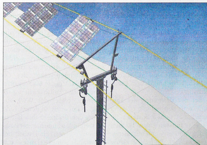
Das Solar Wings System: Auf Seilen befestigte Solarmodule können über Skilifte oder Lawenverbauungen montiert werden.
